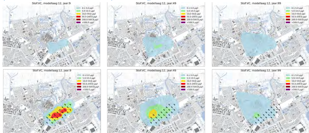
Figuur 13 Verspreiding van VC bovenin het tweede watervoerende pakket (modellaag 12) voor scenario 2 (onderste rij) en referentiesituatie (bovenste rij)
