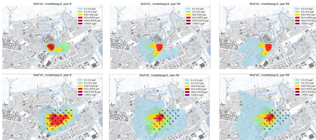
Figuur 8 Verspreiding van VC in het eerste watervoerende pakket (modellaag 6) voor scenario 1 (onderste rij) en referentiesituatie (bovenste rij)
