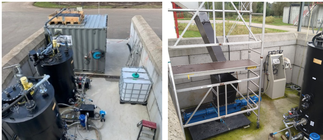
FIGUUR 6 PILOT OPSTELLING OP RWZI AARLE-RIXTEL, LINKS: DE MENG-TANK EN REACTOR MET CONTAINER EN GASZAK VOOR BIOGASOPVANG, RECHTS: OPVANGTRECHTER EN WEEGSCHAAL VOOR AANMAAK VAN HET SUBSTRAAT UIT GEPERST ZEEFGOED
